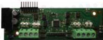
Redundanzmodul zur Vernetzung weiterer IRIS Brandwarnanlagen untereinander oder zur Integration eines externen Bedienfeldes.
