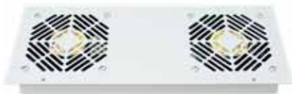
Lüfterkassette für den Dacheinbau in einen Standschrank, zur Steigerung der Wärmeabfuhr. Die Lüfterkassette verfügt über zwei leistungsstarke Lüfter mit Thermostat. In Technikräumen mit einer hohen Staubbelastung wird empfohlen, je nach Typs des Standschrankes, zusammen mit der Lüfterkassette den Filteraufsatz Art.-Nr. 584947 oder Art.-Nr. 584948 zu verwenden.
