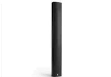
Passiver 100-V-Linienstrahler zur Sprachalarmierung im wetterfesten Aluminiumgehäuse, 8 x 4"-Breitband-Konustreiber, passive 2-Wege-CD-Frequenzweiche, Source Division Waveguide.
