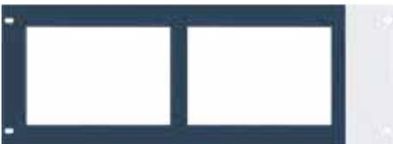
Blindplatte zum Einbau von 2 Feuerwehrsprechstellen DCSF12 oder DCSF1 in den Standschrank. Die Blindplatte hat eine Höhe von 4 HE und verfügt über 2 Ausschnitte für die Sprechstellen bzw. DKM18. Für den Einbau eines digitalen Tastenmoduls DKM18 sind der Einbausatz Art.-Nr. 583507 und ein Standard RJ11 Kabel erforderlich.
