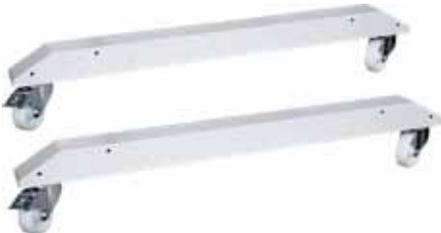
Schwerlastrollsockel zur Aufnahme eines Standschrankes ohne Schwenkrahmen Art.-Nr. 584910. Die Rollvorrichtung besteht aus zwei Schwerlastschienen mit Rollen, die rechts und links unter den Standschrank geschraubt werden. Aufgrund der erforderlichen Standfestigkeit erhöht sich die Tiefe des Standschrankes auf 120 cm.
