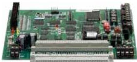
Das serielle esernet®-Interface ist ein Gateway zur Ankopplung von Rechnersystemen, die das EDP (ESSER-Daten-Protokoll) unterstützen. Die Variante EDP (bidirektional) stellt Informationen aus dem esernet® zur Verfügung und eine Fernwirkung ist möglich. Es besitzt einen Steckplatz für ein esernet®-Ringbusmodul und ist damit ein vollständiger Teilnehmer im kurzschluss- und unterbrechungstoleranten esernet®.
