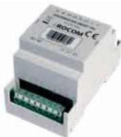
Das DOORMASTER-SMART-PAL-Telefoninterface dient zur Einspielung von Durchsagen über eine analoge Telefonanlage in das VARIODYN® D1 Sprachalarmsystem. Über die Telefonanlage können bis zu 4 unterschiedliche Rufkreise bzw. Bereiche angesprochen werden. Hierfür stehen 1 + 4 Steuerkontakte für Einschaltung und/oder Zonenauswahl zur Verfügung.
